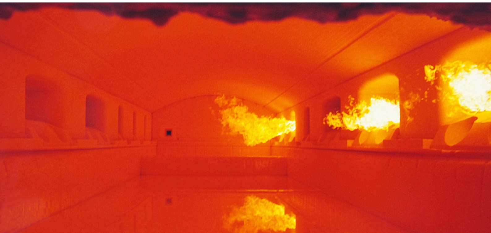
De binnenkant van een industriële glasoven; onderin is het vloeibare glas zichtbaar en aan de zijkanten de vlammen van de gasbranders.
